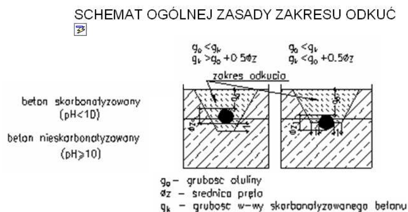
Rys. 6.2 Zakres odkuć i uzupełnień ubytków betonu
